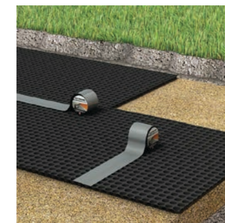
3. Скрепление нахлестов может быть выполнено по трем вариантам: «сухой»; с проклейкой самоклеящейся лентой PLANTERBAND или PLANTERBAND DUO; точечное скрепление беглой сваркой при помощи строительного фена. Для предотвращения капиллярного поднятия влаги рекомендуем проклеить швы лентой PLANTERBAND.
